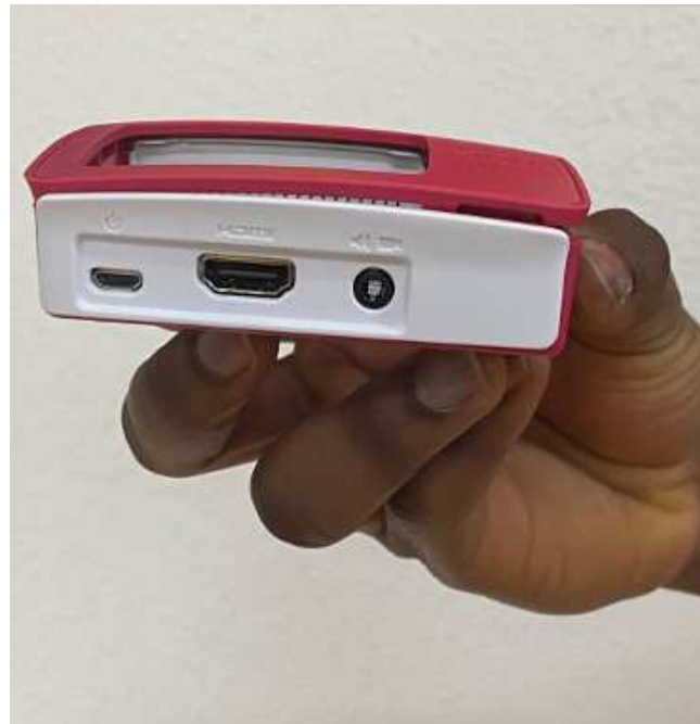
Der Raspberry-Pi-Computer ist kaum größer als eine Kreditkarte und kann auch mit vorhandenen Peripheriegeräten verbunden werden.
